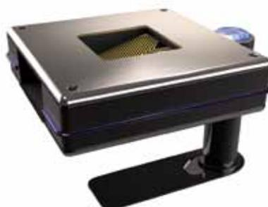
Die Wetterzentrale Quadra® ist gleichzeitig eine Wetterstation und eine Sonnenschutzzentrale für acht Sektoren/Fassadenabschnitte. Die Wetterzentrale erfasst mit ihren Sensoren Wind und Windrichtung, 5 x Helligkeit (Nord, Ost, Süd, West, Sky), 5 x Globalstrahlung (Nord, Ost, Süd, West, Sky), Temperatur, Niederschlag das Wettergeschehen aufs Genaueste.
