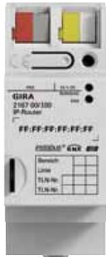
Der Gira KNX/EIB-IP-Router verbindet KNX/EIB-Linien über Daten-netzwerke miteinander. Er nutzt den KNXnet/IP-Standard: Über ein IP-Netzwerk werden KNX-Telegramme zwischen Linien weitergeleitet.
